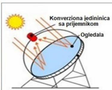
Solarni tanjir - šematski prikaz
