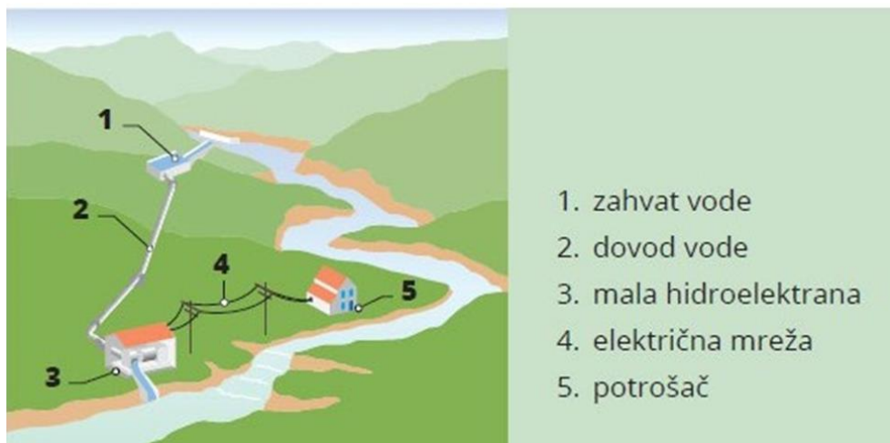
Najčešći raspored osnovnih elemenata male hidroelektrane
