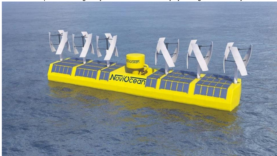
Hibridna elektrana koja koristi energiju talasa, vetra i Sunca. Takozvani Hybrid Energy Converter (HEC)
