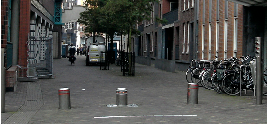
Figura 17 Control de acceso por medio de bolarados retráctiles.
