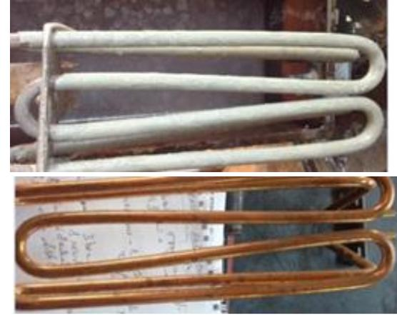
تستعمل بخار الماء المشبع المنتج في خزان بواسطة مقاومتين كهربائيتين أو واحدة حسب الجهاز. الماء المستعمل يبقى ماء الشرب المحمل بالأملاح المعدنية التي تودع على المقاومتين و تغطيهما مما يقلص من التبادل الحراري.
