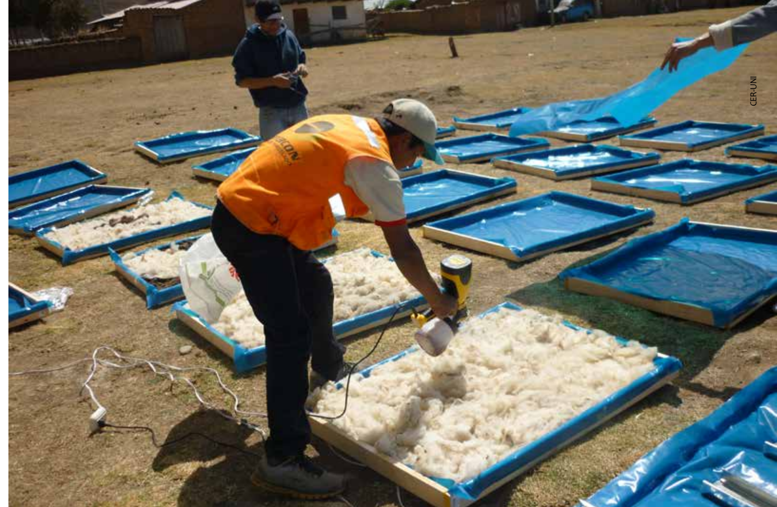
Elaboración de colchonetas de lana para el aislamiento térmico en viviendas de la comunidad de San Francisco de Raymina, en Ayacucho.
