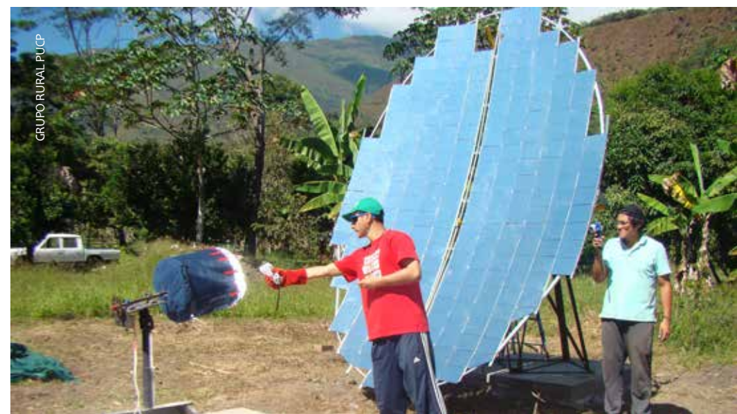
Investigadores comprueban la eficacia de un concentrador solar parabólico para la producción de cacao.
