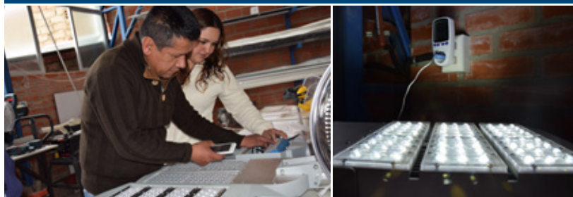
Prueba de iluminación LED
