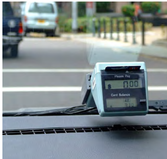
Hình 22 a,b Cổng thu phí ERP (trái) và thiết bị thu phí gắn trên phương tiện (phải) ở Singapore
