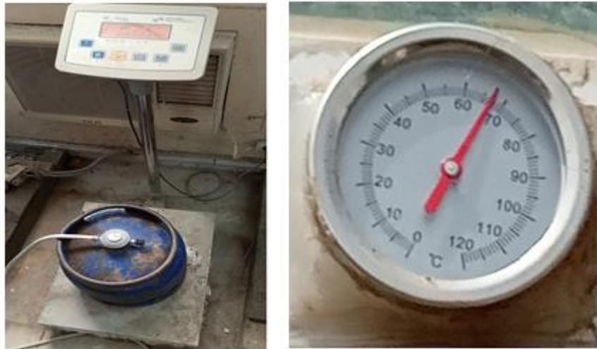
**Figure.3.** Détermination du débit massique et l’affichage du thermostat
