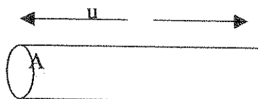
Fig.3.5.3 A massa de coluna é igual a (\rho A u) e a energia cinética é igual a 1/2(\rho A u)u^2 (Renewable Energy Resources por John Twidell and Tony weir,1986)
