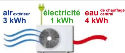
Énergie thermique à basse température prélevée dans l'environnement
