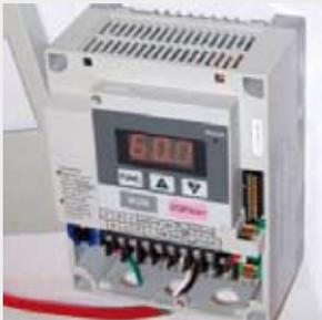
La consommation électrique de bon nombre de moteurs fonctionnant à vitesse fixe et connectés directement au réseau peut être réduite par l'utilisation d'un variateur de vitesse. Le gain est particulièrement intéressant dans le cas de ventilateurs ou de pompes centrifuges fonctionnant avec un couple variable. En effet, dans ce cas, le couple et la puissance sont proportionnels au carré respectivement au cube de la vitesse.
