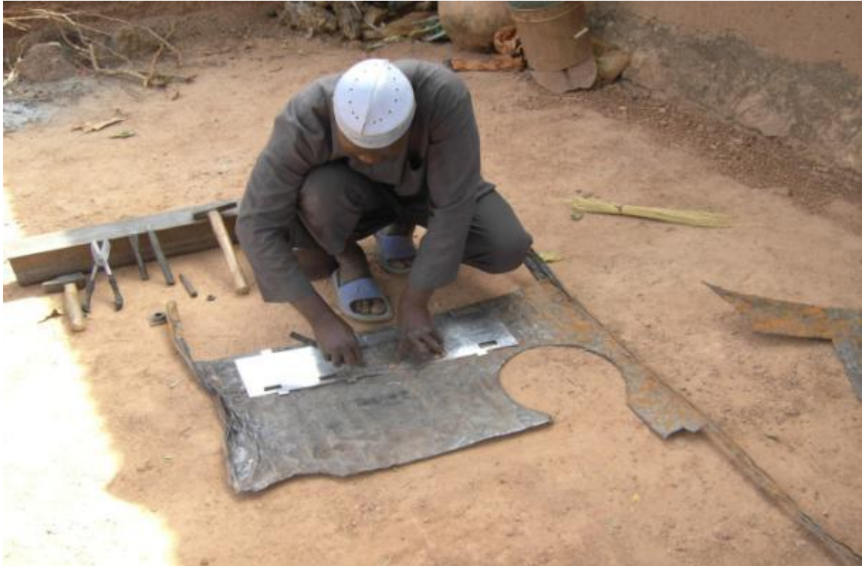
Photo 1 : Techniques de fabrication des foyers améliorés/ traçage à l'aide de gabarits
