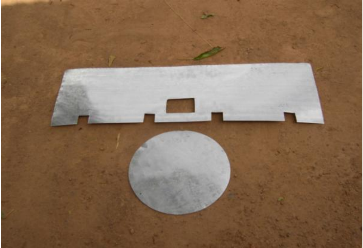
Photo 10 : gabarit du Ouaga métallique
