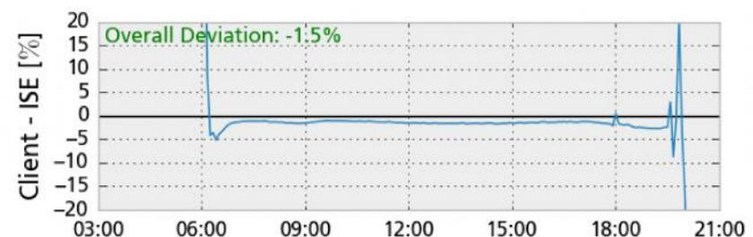
Fig. 2: Comparación de valores de piránómetros de ISE y cliente
