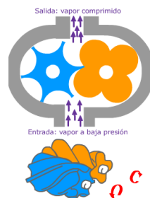
Figura 92 Compresor de tornillo
