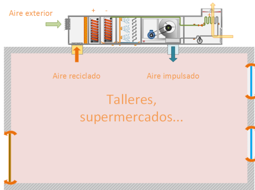
Figura 149 Equipo de climatización con ventilación integrada tipo Rooftop
