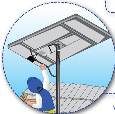
Los cables y conexiones del panel solar no están sueltos o colgando.
