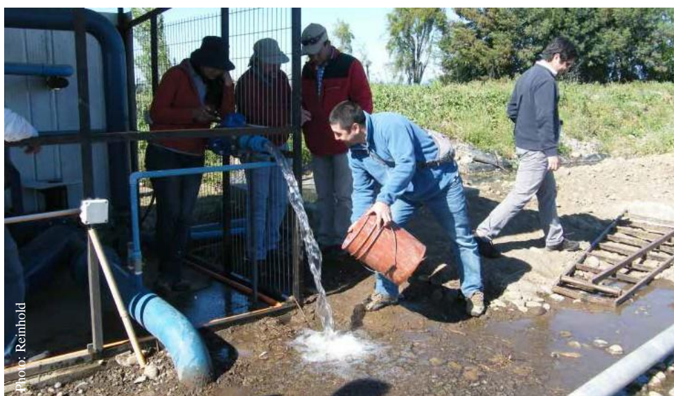
Medición del flujo de agua (Fuente: Reinhold Schmidt)
