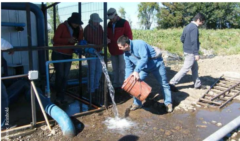
Medición del flujo de agua
