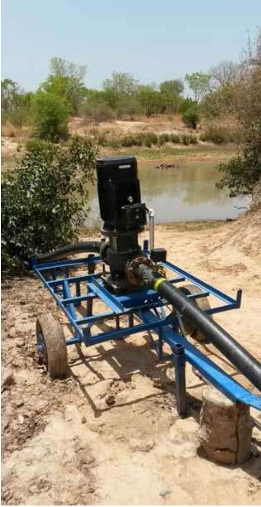
شكل 2: مضخة سطحية على هيكل متحرك (المصدر: Lennart Woltering)
