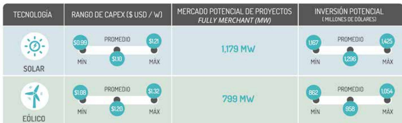
Figura 7 Rango de costos de inversión de acuerdo al tipo de tecnología, capacidad esperada a instalarse (MW) e inversión potencial (US$ millones) – Fuente: Estudio de Energías Limpias CESPEDES, PRODESEN, Lazard, IEA, IRENA
