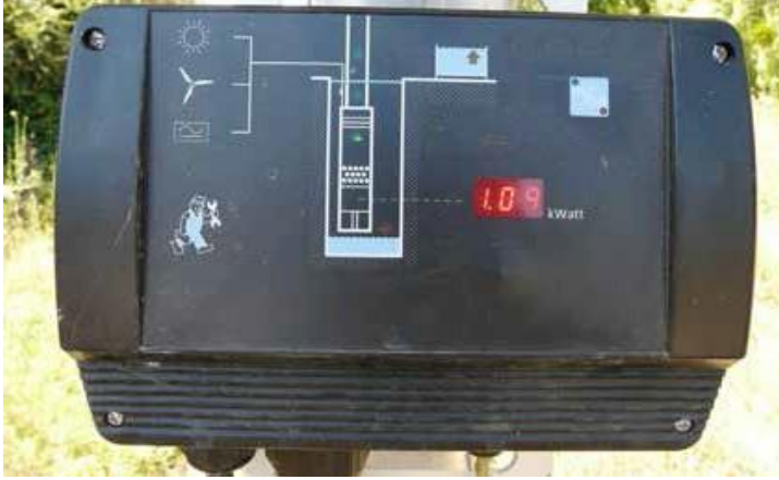
Controlador con visualizador e indicador LED de fallo
