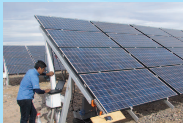
Medición de curvas corriente vs tensión (I-V).
