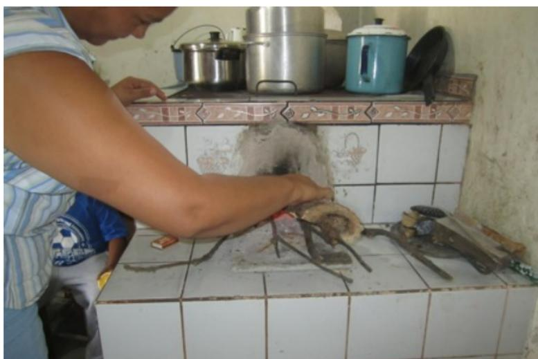
La Eco-Estufa Justa, una vez encendida, se alimenta con más leña a medida que se va quemando dentro de la cámara de combustión, teniendo la precaución de siempre mantener la llama al fondo de la cámara de combustión.
