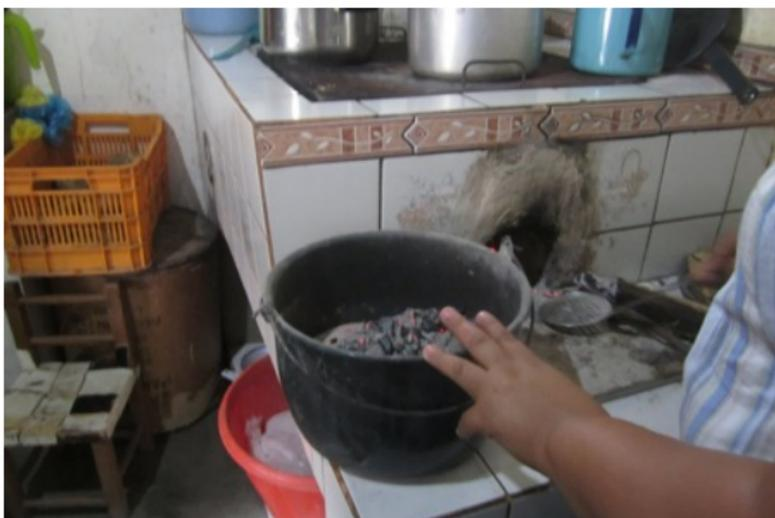
Se retiran las cenizas dentro de la cámara de combustión, producidas en la quema de la leña en el día anterior.
