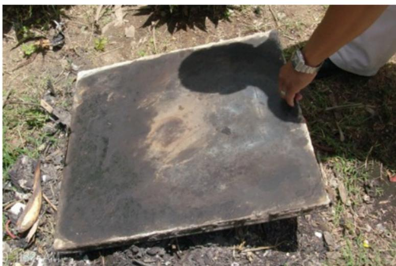
La plancha se debe colocar de manera que el refuerzo de lámina se ubique sobre la cámara de combustión.
