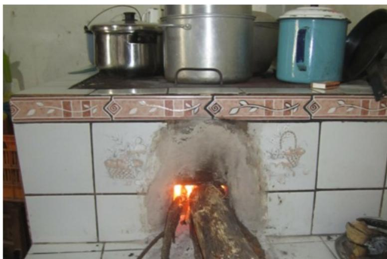
**Nota:** No es recomendable encender la estufa colocando queroseno en el interior de la cámara de combustión; Es preferible mojar pedazos de madera con queroseno, encenderlos afuera de la cámara de combustión y luego introducirlos en la misma .
