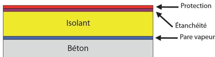
Figure 10 : Exemple de toiture terrasse en b ton.
