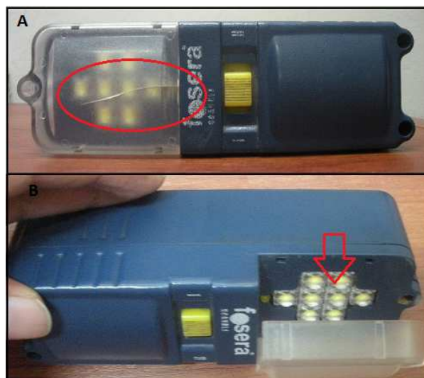
Figura 3: Vista de los daños físicos. A: lámpara LF_UNI_121122_09. B: lámpara LF_UNI_121122_04
