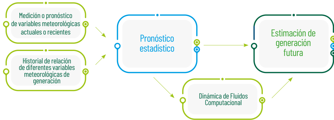
Figura 11. Diagrama de bloques sobre el proceso de pronóstico estadístico con Dinámica de Fluidos computacional
