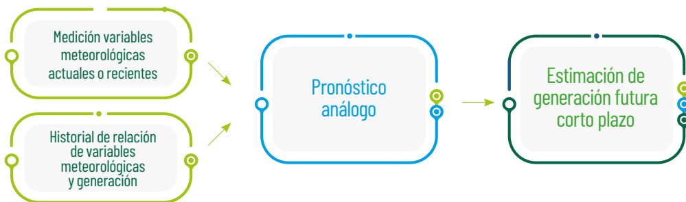
Figura 2. Diagrama de bloques sobre el proceso del pronóstico análogo
