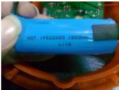
Figura 8. Batería en lámpara d.light S300
