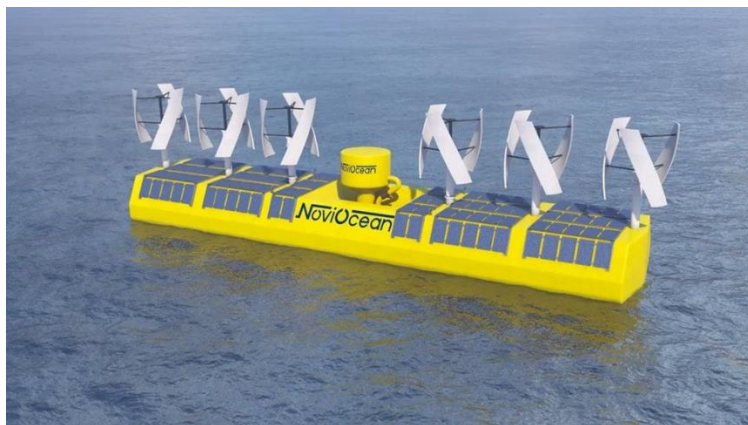
Një termocentral hibrid që përdor energjinë e valëve, të erës dhe të diellit. I ashtuquajturit Konvertues Hibrid i Energjisë (HEC)
