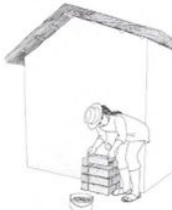
3. Cuando llegamos al nivel del hueco del muro, comenzamos a construir la chimenea de adobe dejando un hueco en la primera hilada que servirá para la limpieza de la chimenea.
