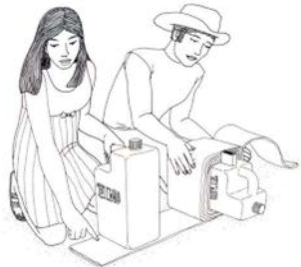
Antes de colocar el sombrero al bidón que va parado, envolvemos el bidón con yute o bolsas vacías de cemento con un espesor de 3 cm. (el ancho de una caja de fósforos parada).
