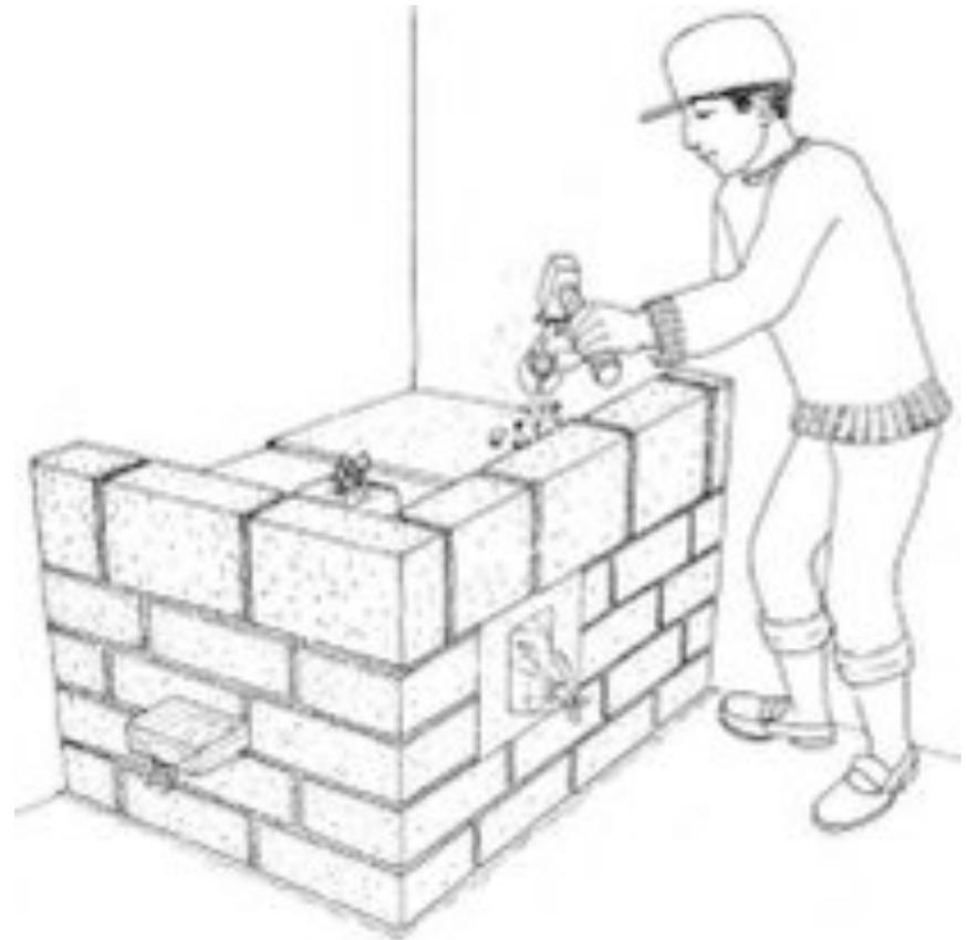
El hueco debe tener 10 cm. o un puño de ancho y debe ubicarse a la altura de la parte superior de la envoltura.
