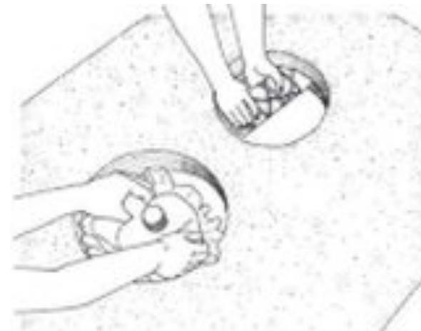
5. Si hemos seguido bien las instrucciones al construir la Cocina Malena, las medidas internas serán las correctas y solo tendremos que afinar el interior de la cámara de combustión, de las hornallas y los conductos.
