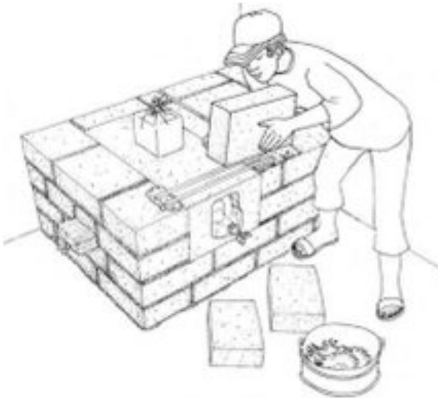
4. Para formar el puente colocamos dos adobes parados con mortero de barro de manera que la junta de los dos adobes se ubique en el centro de la boca de la cámara de combustión.
