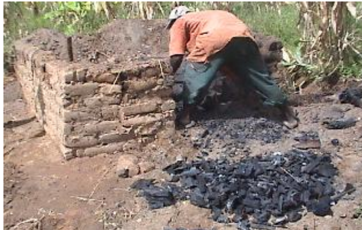
Fig. 19: Retirada do Carvão Vegetal. Fonte: autor (Janeiro/2011)
