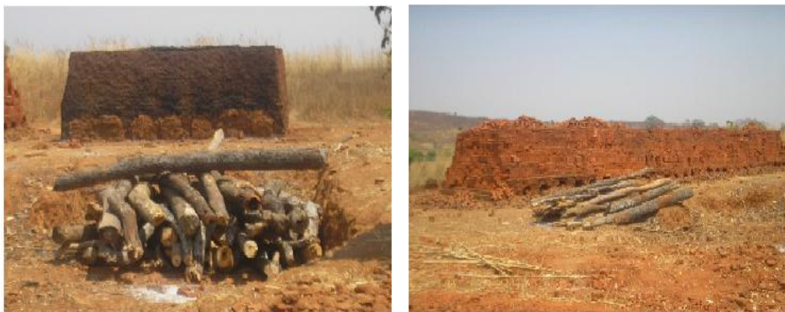
Fig. 22: A esquerda: Queima de tijolos. A direita: Tijolos já queimados. Uma das causas que contribuí para o desflorestamento no distrito de Angónia. Também pode ser usada para explicar o fenómeno de transmissão de calor. Fonte: autor (Setembro/2010)
