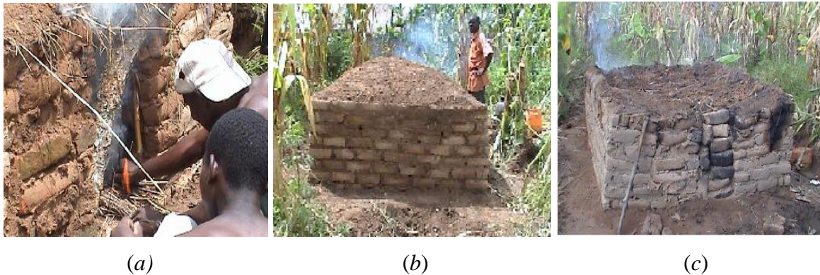
Fig. 18: A imagem (a) representa a colocação de fogo no forno, a (b) representa o início da combustão e a (c) a parte final da carbonização. Fonte: autor (Janeiro/2011)
