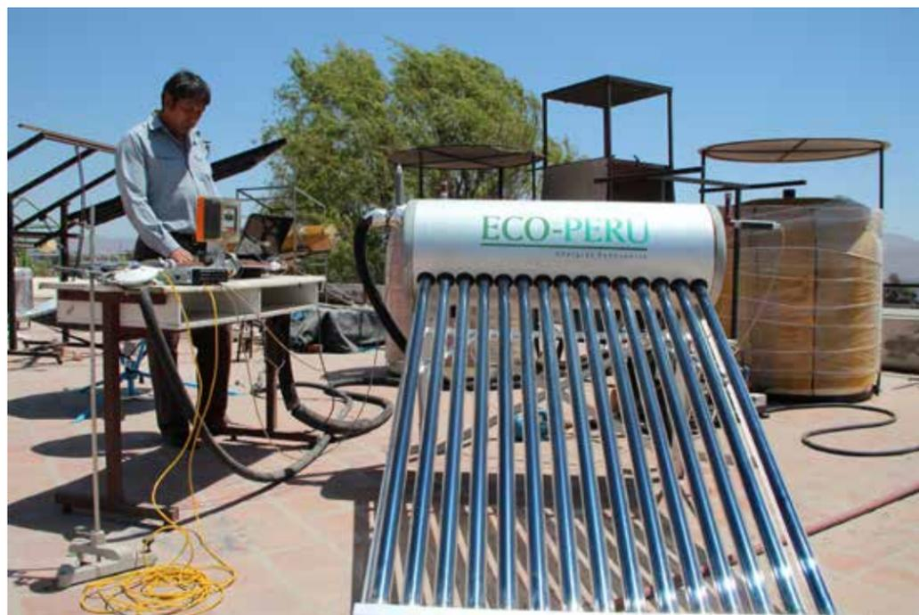
El proceso de validación se realiza a través de un datalogger, que sirve para registrar los datos de temperatura al interno y externo de la terma.
