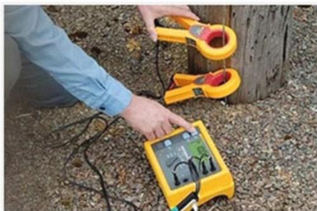
Тестирање на инсталација за громобранска заштита
