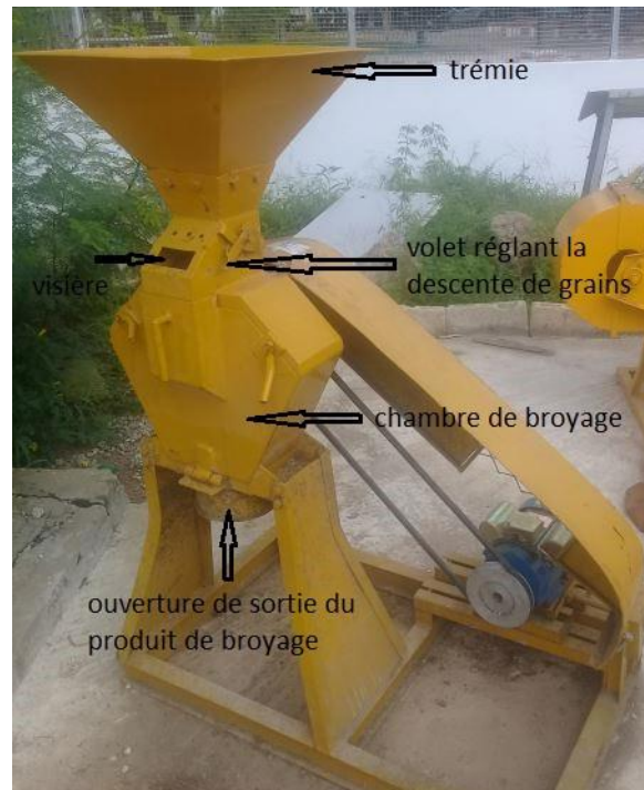
Figure I.1 – Vue du moulin à grains
