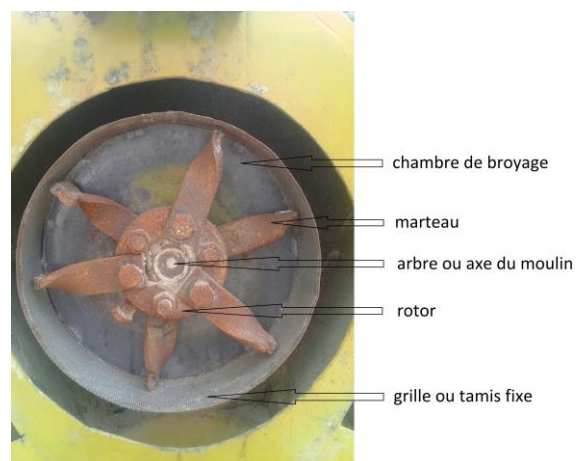
Figure I.2 – Chambre de broyage du moulin à grains
