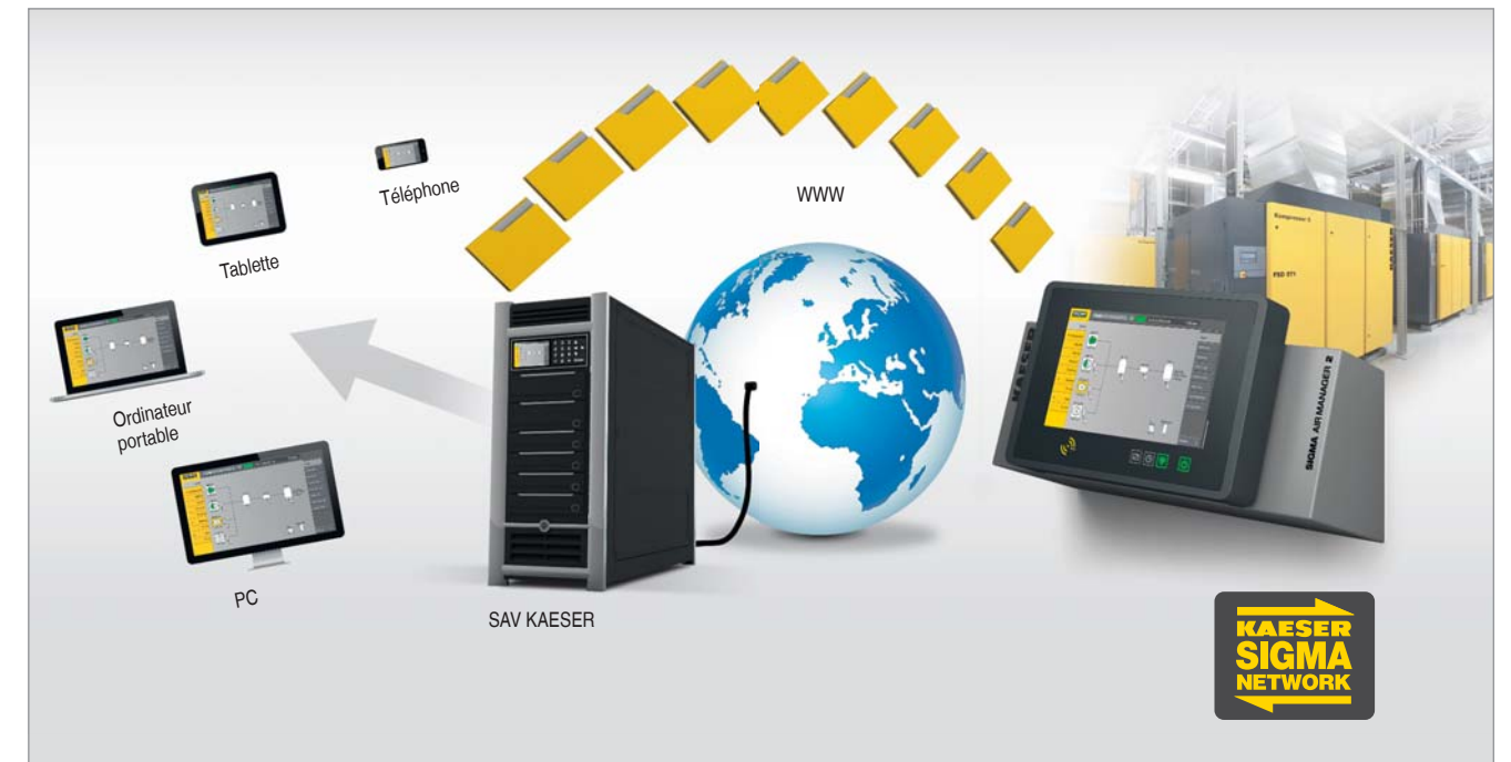
Fig. 7 : La connectivité de la commande prioritaire contribue au rendement de la station d'air comprimé
