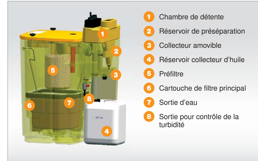
Fig. 2 : Système de séparation gravitaire des condensats issus de l'air comprimé
