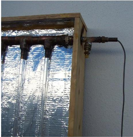
Figura 90: sensor dentro de colector
