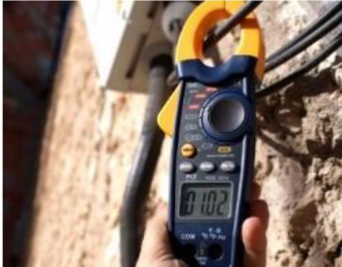
**Figura 105: Lectura con amperímetro de gancho**
