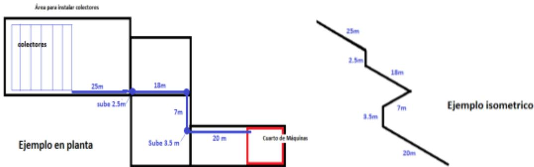
Figura 33: Recorrido entre Azotea y cuarto de máquinas
