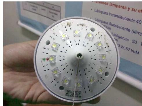
Figura 12. Residuos de insectos que se encuentran en la zona de los LEDs de la lámpara LF_UNI_111004_05
