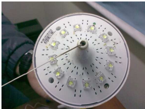
Figura 11. Residuos de insectos que se encuentran en la zona de los LEDs de la lámpara LF_UNI_111004_03
