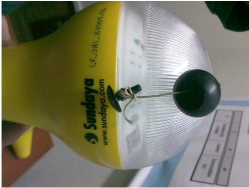
Figura 13. Pita que sirve como interruptor cortada y la perilla al final dañado; de la lámpara LF_UNI_111004_06
