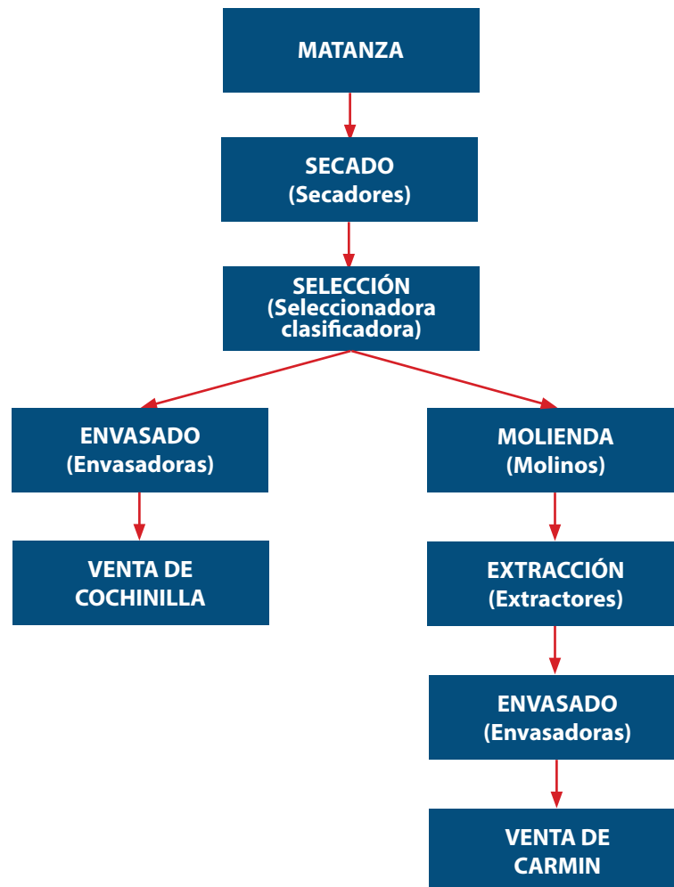
Figura 1: Flujograma del procesamiento de la cochinilla.
