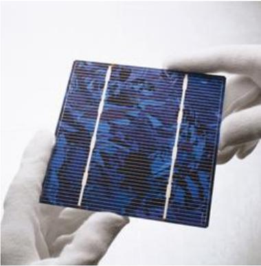
La cellule photovoltaïque est l'unité de base qui permet de convertir l'énergie lumineuse en énergie électrique.
