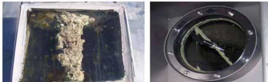
GRÁFICO 3.12. Azufre elemental ( S^0 ) depositado dentro del biodigestor
