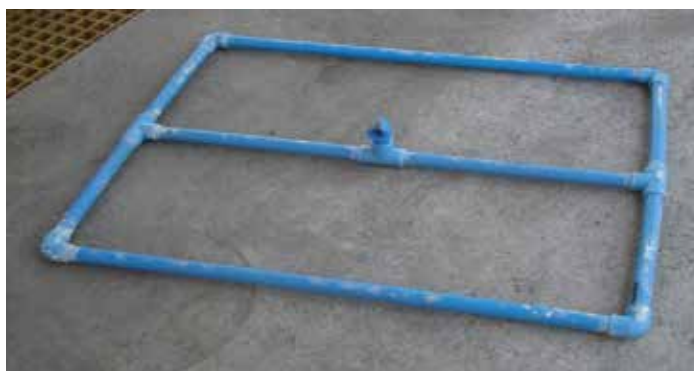
GRÁFICO 4.11. Difusor de aire fabricado con tubería de PVC
