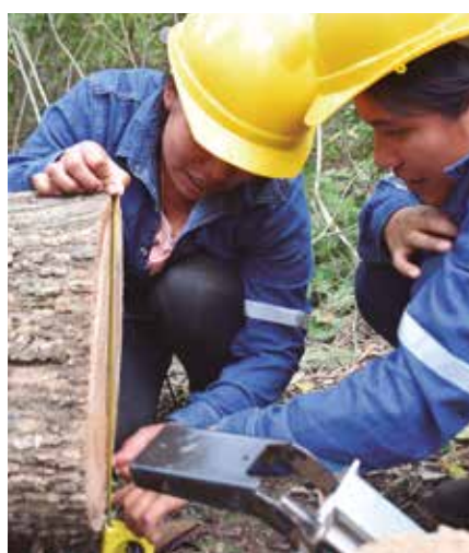
Medición del diámetro mayor (foto izquierda), el largo (centro) y el diámetro menor (der.) en una troza o sección
