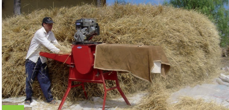
Dreschen von Getreide: Durch einen mechanischen Prozess werden die Getreidekörner herausgelöst
