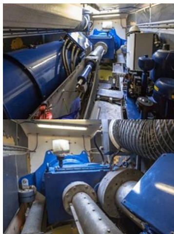
Unutrašnjost gondole vetroturbine sa osovinom, menjačem, kvačilom i sistemom hlađenja
