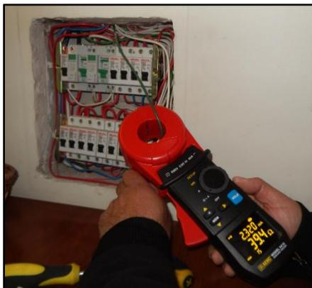
**Figura 57: Ejemplo de medición de la resistencia del conductor de puesta a tierra, con un resultado correcto, menor a  $20\Omega$**
