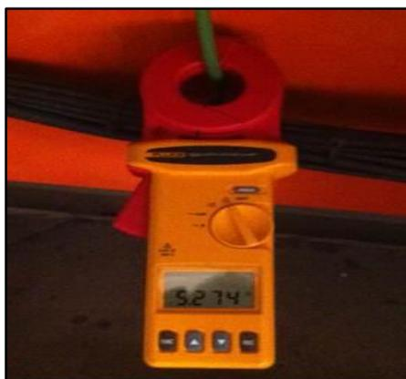
El apéndice 7.3: “Procedimiento de Medición de Resistencia de Puesta a Tierra de la NCh 4/2003” describe una metodología simple llamada Método de Caída de Potencial. Para este método se utilizan dos electrodos: uno de referencia (tierra de referencia) y otro auxiliar (sonda de medición), y un equipo llamado óhmetro (o megóhmetro) u otro que cumpla una función equivalente.
