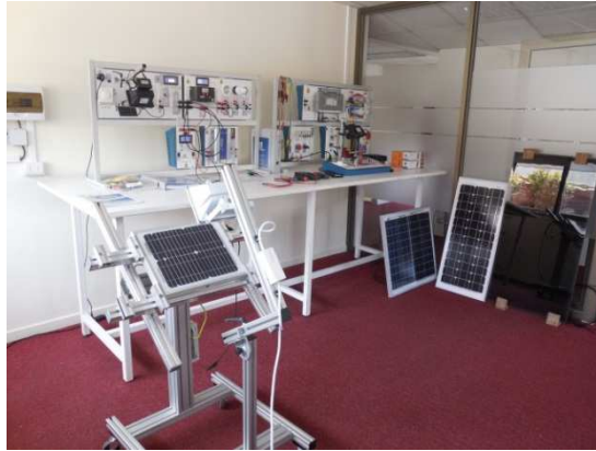
Sistema Didáctico FV módulos para experimentar y desarrollar un entrenamiento en distintos sistemas FV (on-grid y off-grid)
