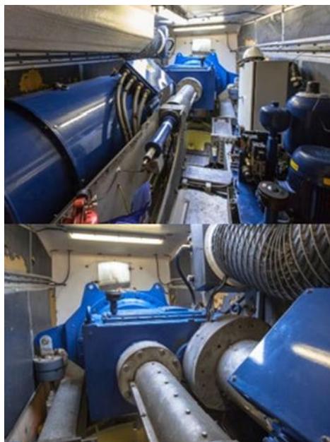
Внатрешност на гондолата на ветерната турбина со вратило, менувач, квачило и систем за ладење
