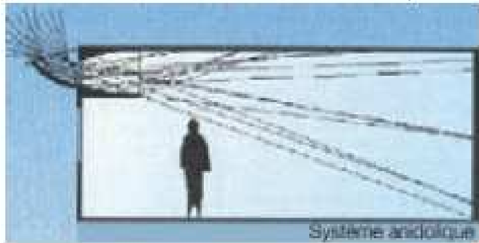
Illustration 4.8: Effet de l'utilisation d'un système anidolique
