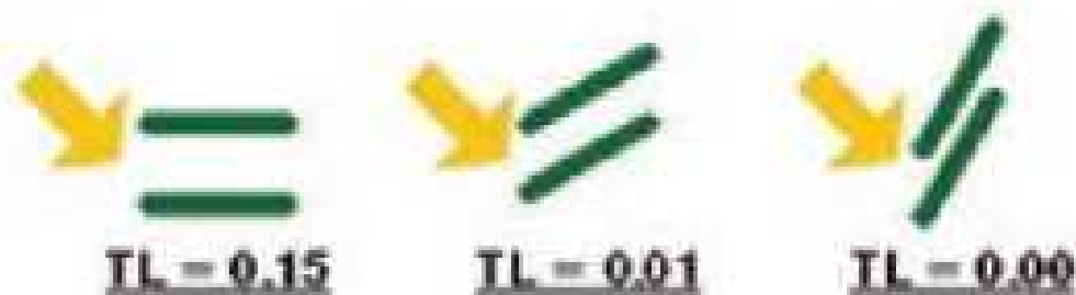
Illustration 4.13: Variation des coefficients de transmission lumineuse d'un store vénitien de 16mm
