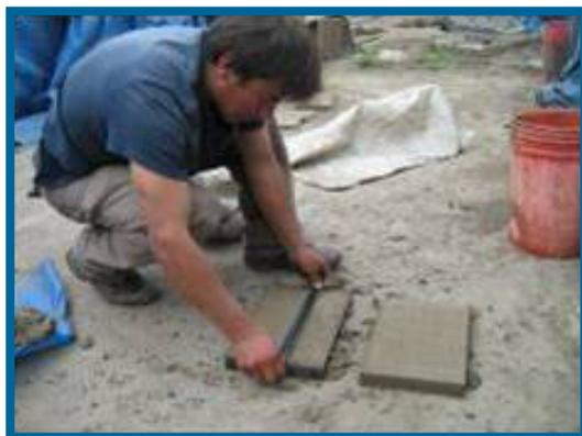
4. *Modelado.* Es el momento en el que la arcilla pasa de constituir una pasta amorfa a presentar un cuerpo definido. Existen tres tipos de modelado para la obtención de vasijas: a mano, en torno y con molde. Para la fabricación de cámaras de combustión es recomendable emplear moldes para las distintas piezas.
