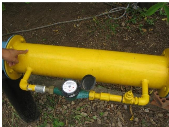
Medición del agua de la fuente con un medidor de agua proporcional de bajo costo.
