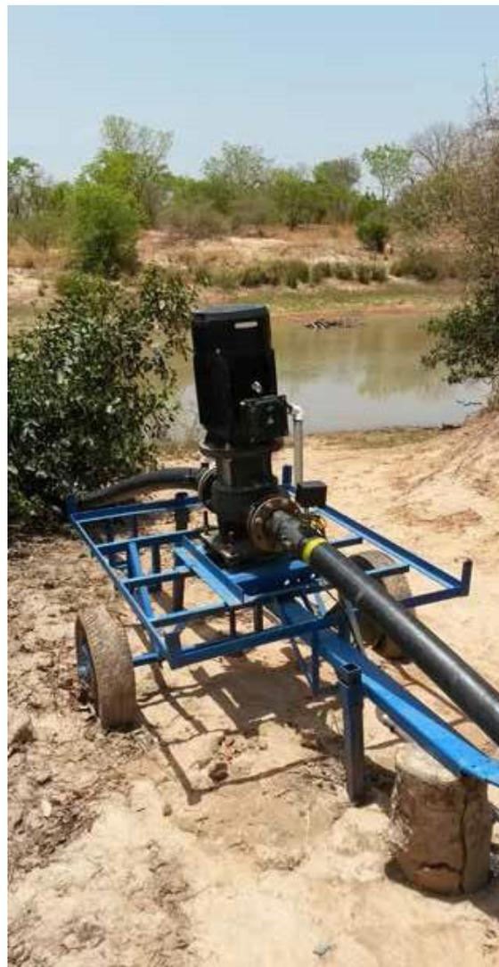
**Bomba de superficie montada sobre una estructura móvil**
