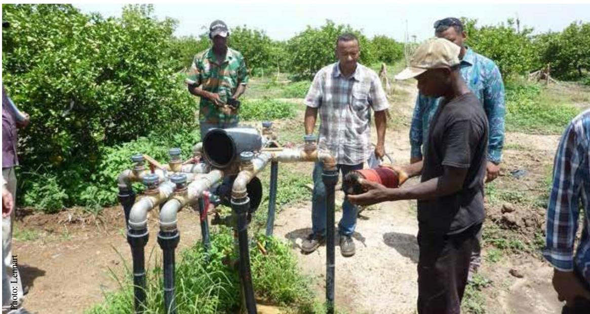
Cabezal de riego con filtro de disco y múltiples válvulas que guían el agua a diferentes secciones del sistema de riego
