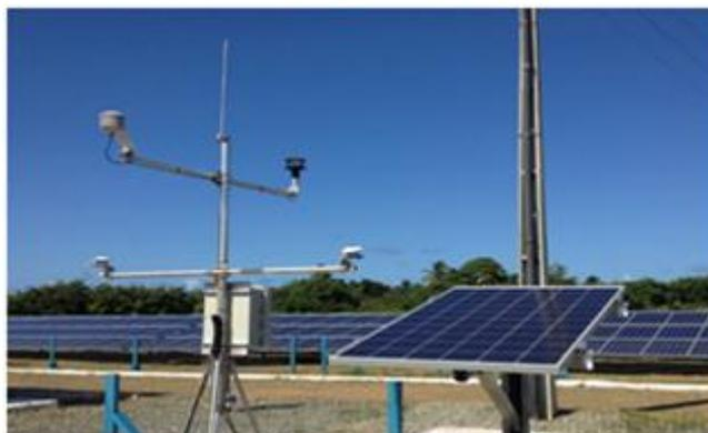
Messstation, Referenzpanel und im Hintergrund die Solaranlage
