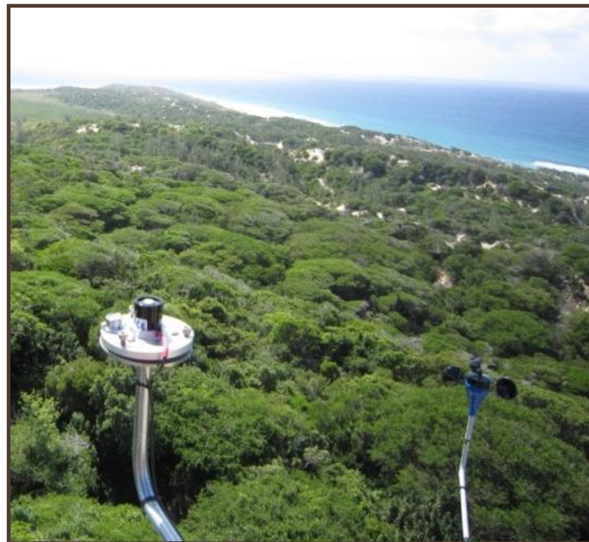
Fig 2. Piranómetro instalados em Pomene, Província de Inhambane
