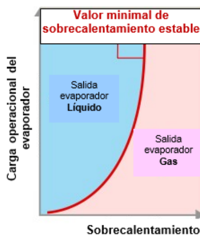
Figura 54 Valor mínimo de sobrecalentamiento estable
