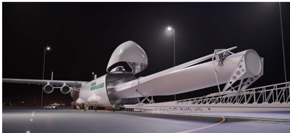
Specijalizovani avion za transport lopatica vjetroturbine
