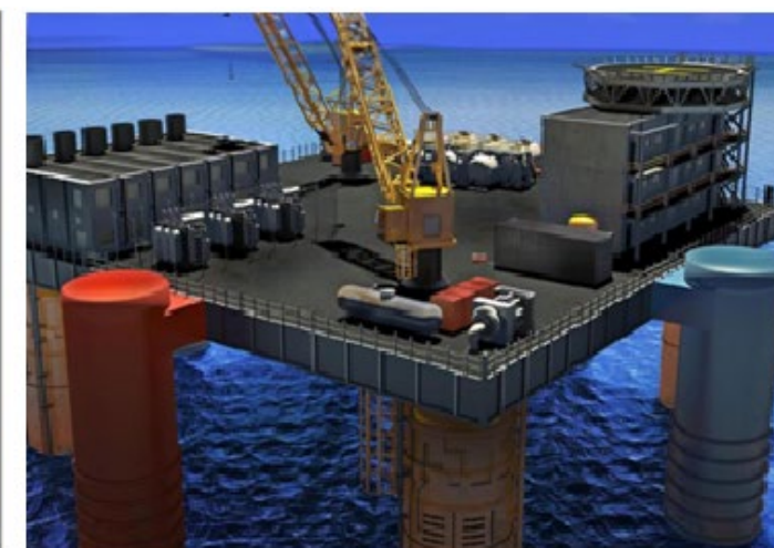
Plutajuće OTEC postrojenje
