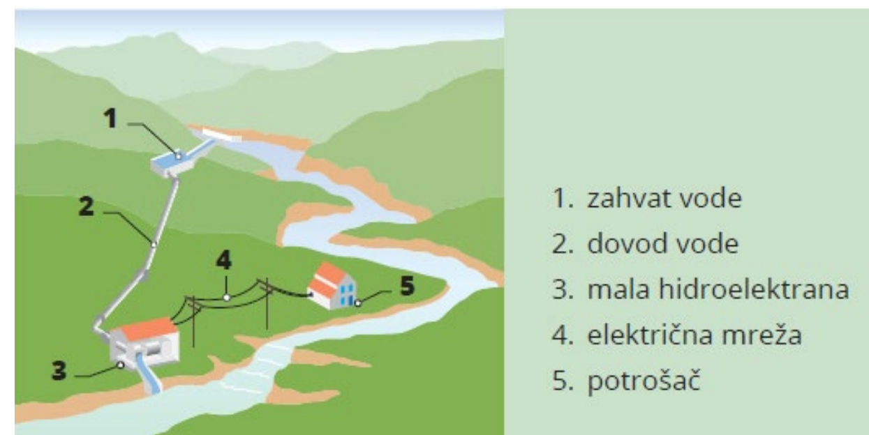
Najčešći raspored osnovnih elemenata male hidroelektrane
